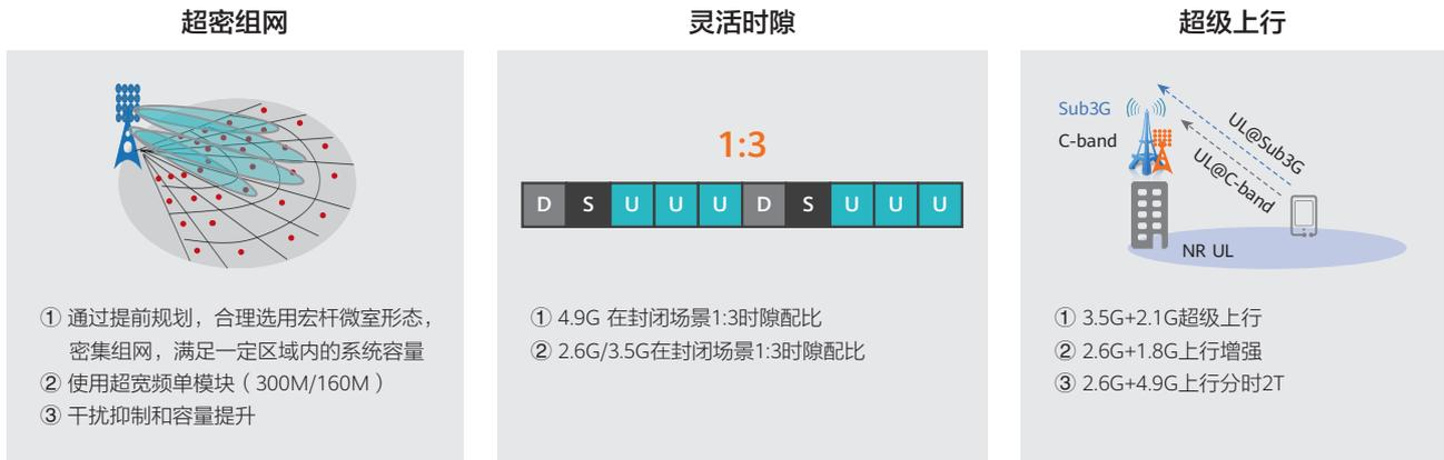
图 2.1.2.3 多种技术手段灵活应对电网上行大带宽需求
