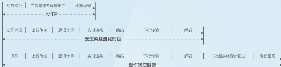
图 2-2 端云异步渲染技术方案下的 MTP、云渲染及流化时延、操作响应时延
