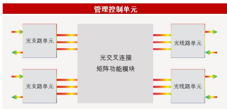
图 14 全光交换结构示意图
