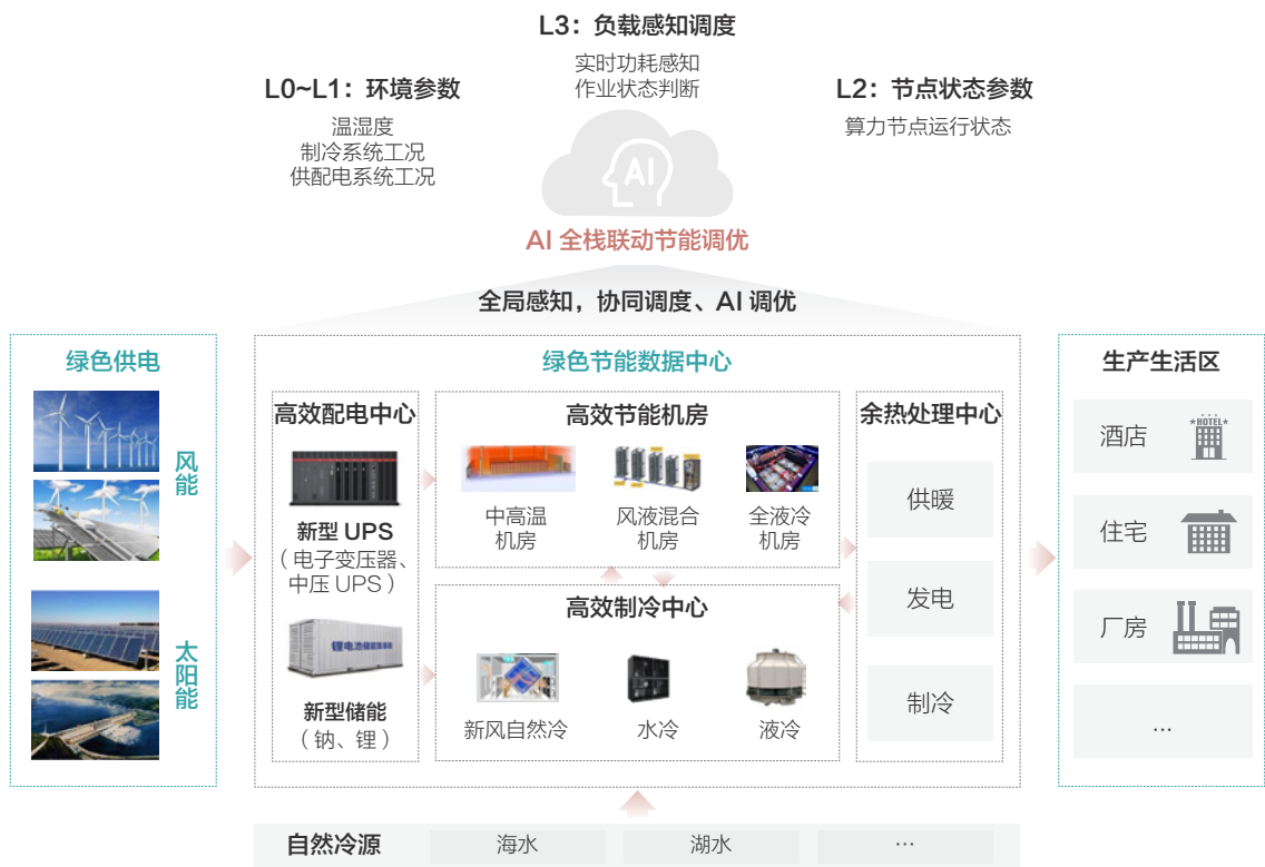
图 4-2: 新型数据中心全绿色供电及动态制冷参考架构
