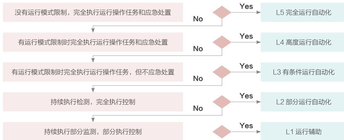
图 2-1 数据中心自动化发展的五个阶段
