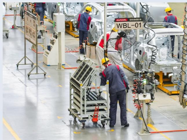
2021 年起，长城精工联合中国联通河北公司和华为开展了“5G-A + 工业控制”的产业联创，基于 5G-A 网络特征中的 URLLC 毫秒级稳定时延，在河北保定精工自动化工厂内搭建了全球首条无线化柔性产线，这是 5G-A 在高端工业控制中的首次应用。改造后的汽车制造产线，所有的设备迭代为无线连接，支持灵活组合生产模块。设备发出指令到设备端仅需毫秒级，且高速运行稳定不掉线。对比传统产线，没有了工业线路的束缚，大大减少了由于线缆拖拽、插针磨损而导致的故障停
