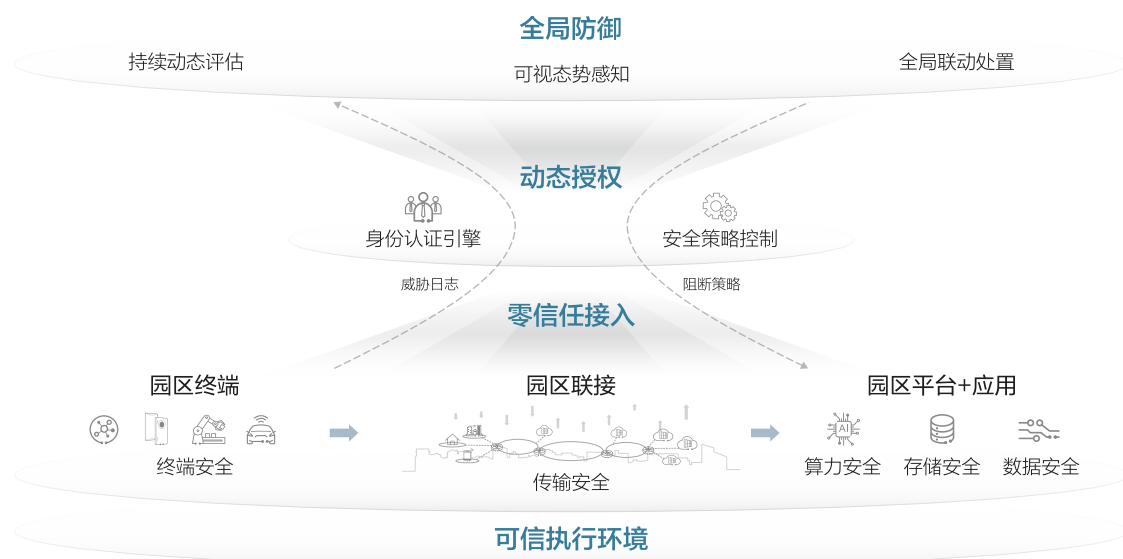
图 3-30: 园区安全零信任架构
